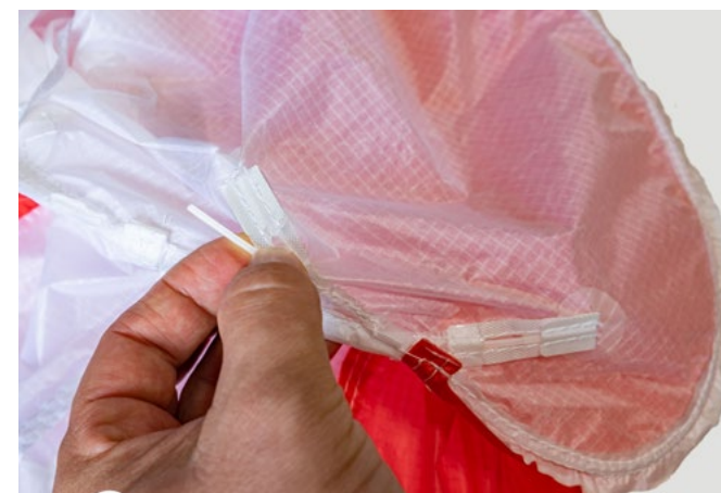
Heben Sie die Nylonstab aus der Tasche am Untersegel. Foto 2.
